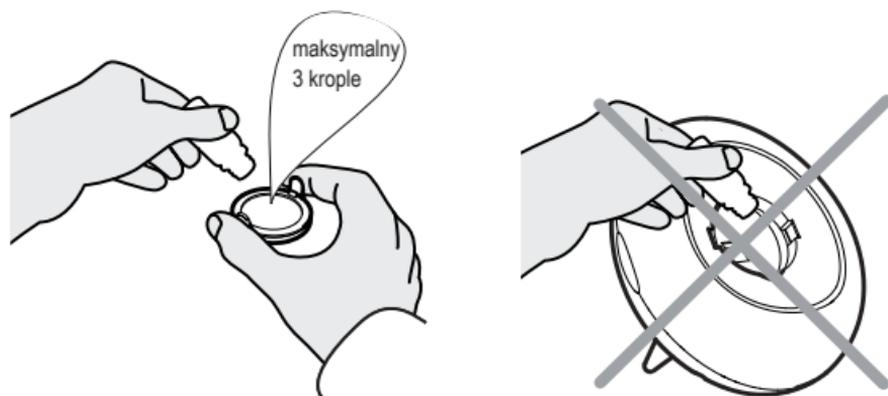
**UWAGA :** nie należy wlewać olejku zapachowego do wgłębienia znajdującego się poniżej kapsułki, ponieważ może to spowodować uszkodzenie urządzenia. Brak przestrzegania tego zalecenia spowoduje unieważnienie gwarancji.
